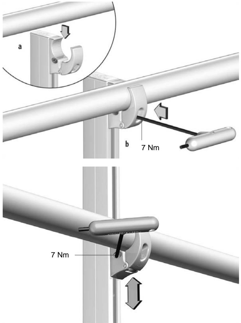
Mit der seitlich zugänglichen Schraube (TX0036 M5 x 18; Anziehmoment 7 Nm) ist eine nachträgliche Höhenjustierung der Geländerprofile jederzeit möglich. Mit dem Innensechskantschlüssel Nr. 4 wird der Halter am Stützenprofil leicht gelöst, der Halter im Nutprofil in die gewünschte Position gebracht und wieder arretiert.
