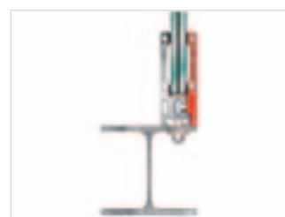
Montage auf Stahl, Direktmontage von oben
