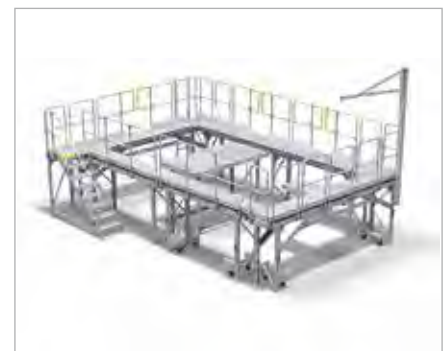
Fahrbarer Prüfstand mit Schiebekassetten und Lastkran
