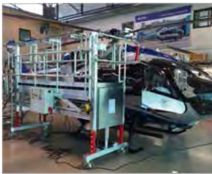
Wartungsbühne mit elektrischer Höhenverstellung
