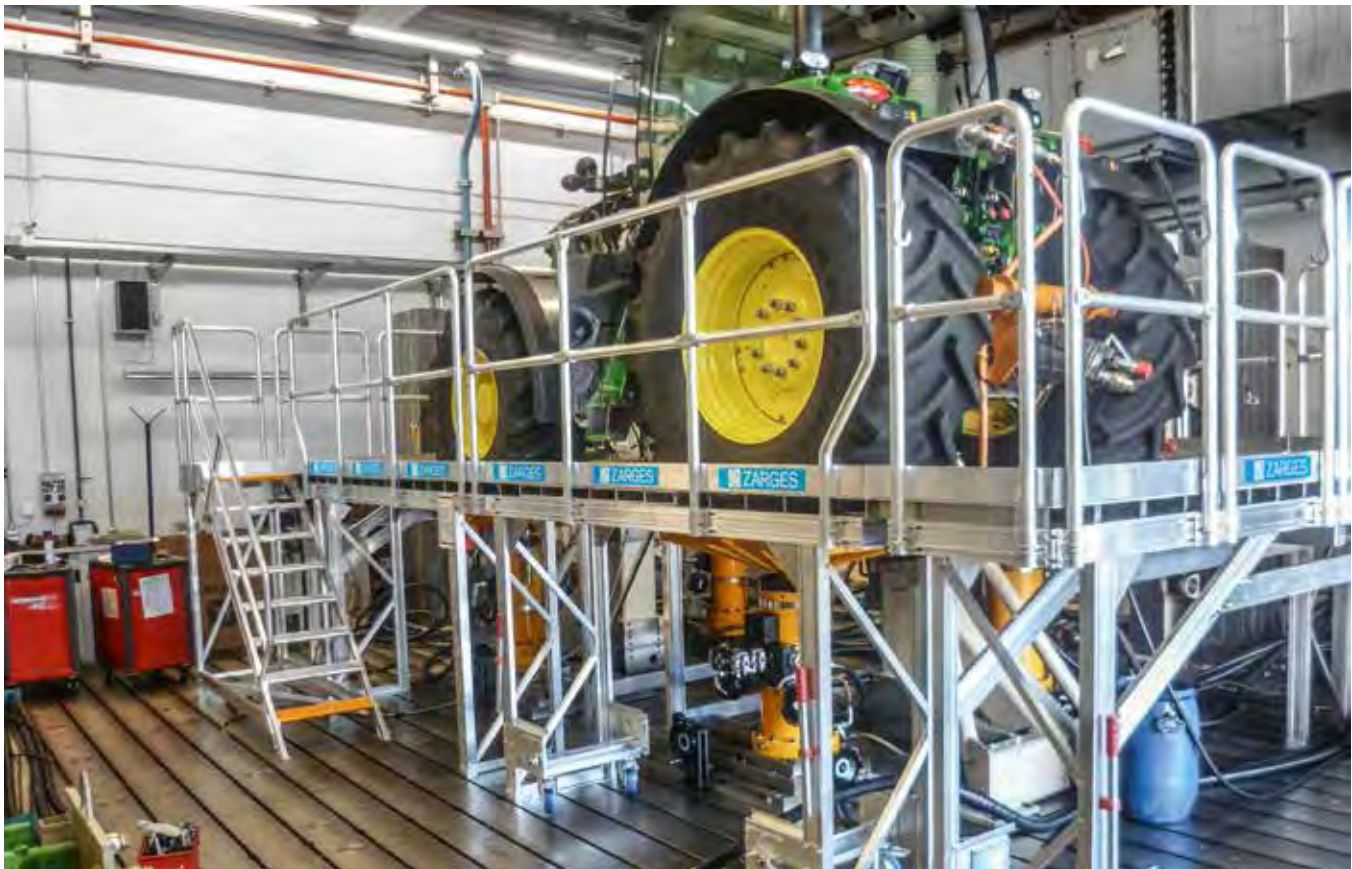
Arbeitsbühne mit Treppenzugang
