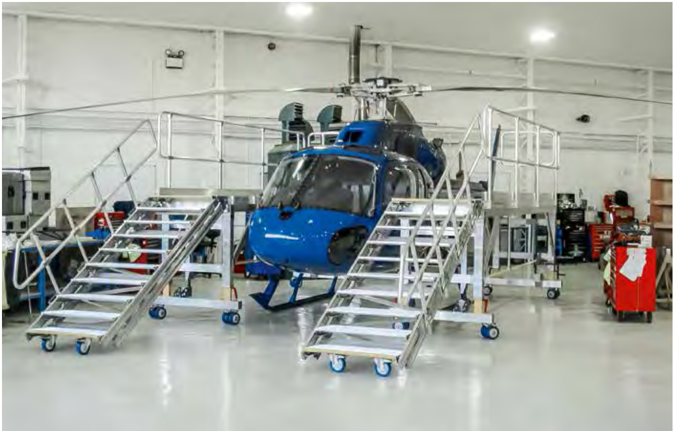
Höhenverstellbare Wartungsplattform für einen EC 145
