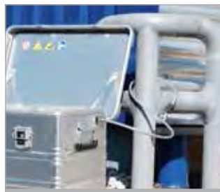
Zusätzliche Sicherung durch Verankerungsseil
