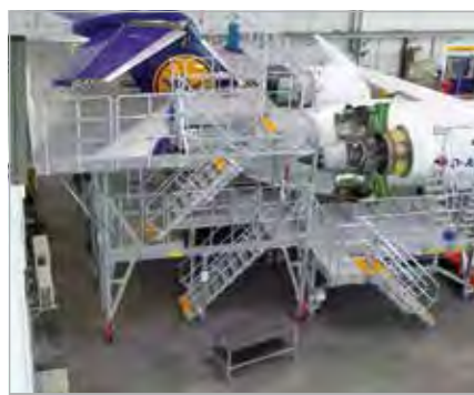
Höhenverstellbares Heck- und Triebwerksdock für eine CRJ900
