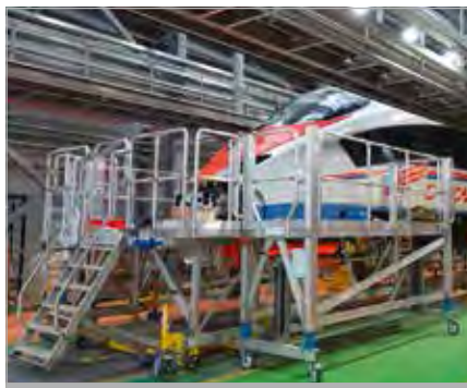
Modulares Arbeitsbühnensystem für Front- und Seitenzugang
