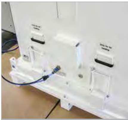
Wasserdampfdichter Behälter bei Dichtheitsprüfung durch Überdruck
