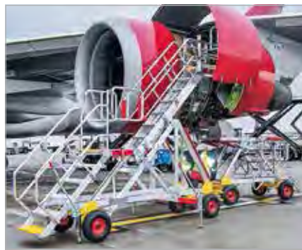
Triebwerkstreppe (UCAS). Schmales und strebenfreies Design für bessere Erreichbarkeit
