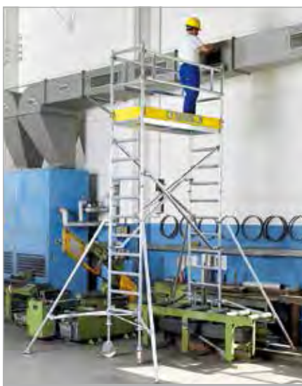
Strebenfreie Fahrgerüste gibt es in zwei Breiten (0,75 m und 1,35 m) und sie können bis 10,40 m aufgebaut werden. Die Strebenfreiheit beträgt bis 1,90 m (mittig).
