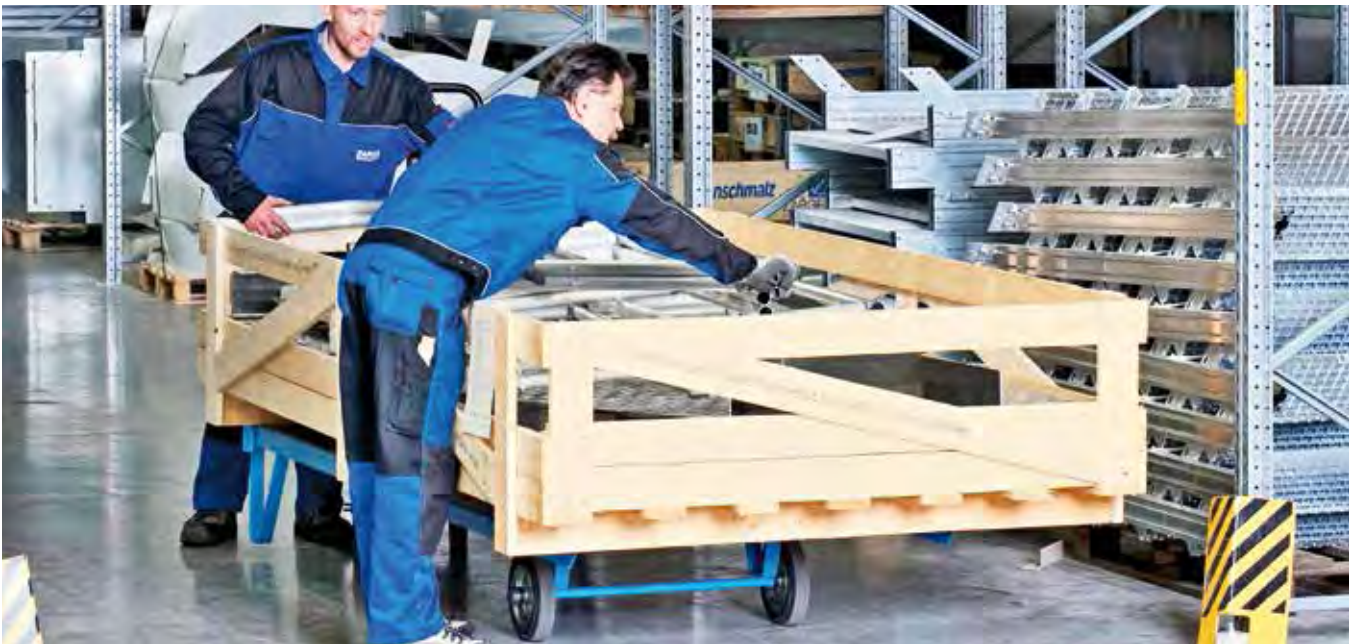
Innenausbauten sektionsweise und einbaufertig verpackt
