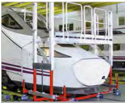
Höhenverstellbare Frontarbeitsbühne mit Schienenfahrwerk
