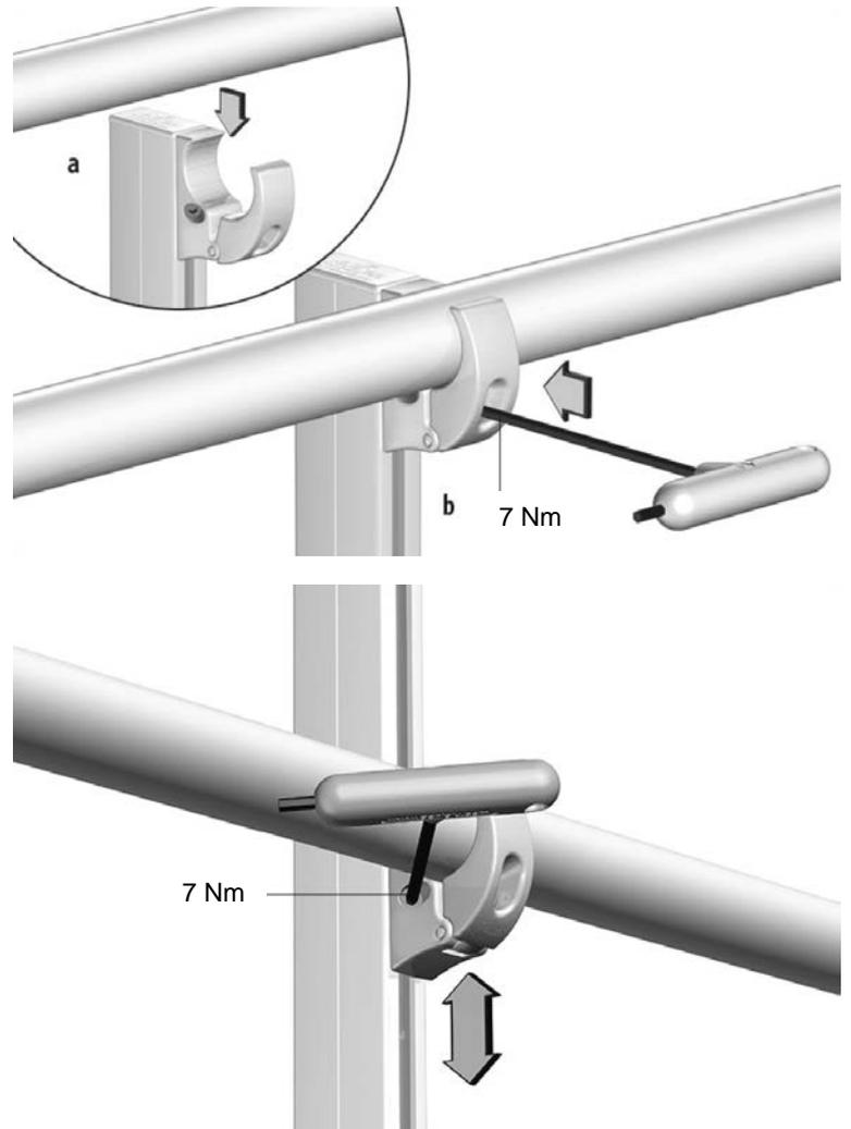
Mit der seitlich zugänglichen Schraube M5 x 18 (TX0036) ist eine nachträgliche Höhenjustierung der Geländerprofile jederzeit möglich. Mit dem Innensechskantschlüssel Nr. 4 wird der Halter am Stützenprofil leicht gelöst, der Halter im Nutprofil in die gewünschte Position gebracht und wieder arretiert.
